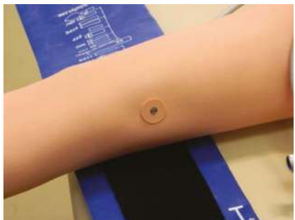
Рис. 17. Сенсор, регистрирующий положение компрессионной манжеты
