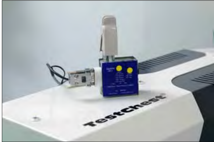
Илл. 8. Стандартный датчик пульсоксиметра присоединен к искусственному пальцу
