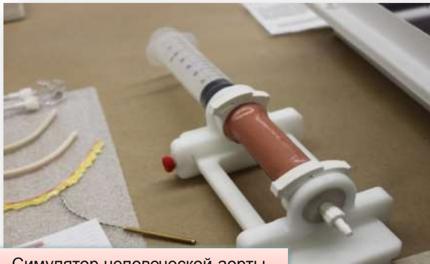
Симулятор человеческой аорты с гидравлическим поршнем
