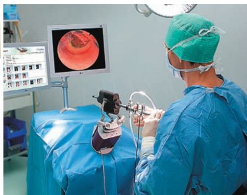
Симулятор гистероскопии HystSIM швейцарской фирмы VirtaMed, 2001. На переднем плане — манипулятор с обратной тактильной связью производства XiTact
