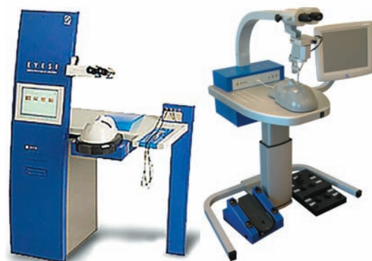
Симулятор офтальмохирургии EYESI. VRmagic (Германия, 2002) Слева — дизайн 2002 г., справа — современный вариант исполнения симулятора
