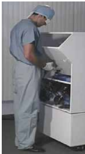
Симулятор хирургического шва BDI Surgical Simulator, 1997 г. Boston Dynamics. США,
