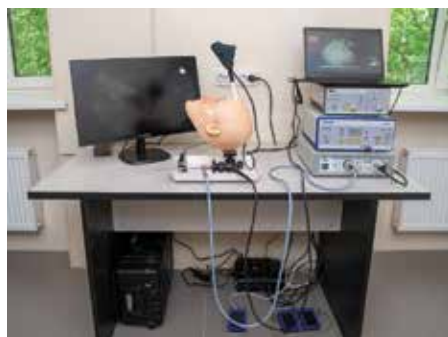
Рис. 4. Симулятор для выполнения операций на придаточных пазухах носа
